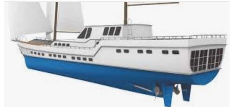
Jacht motorowy: Kadłub (powłoka), pokład (płyta)
